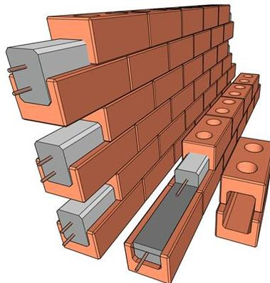
Le dimensionnement des ouvertures peut conduire à multiplier par deux ou trois l'appareillage des linteaux sur plusieurs rangs. Il est recommandé sur les grandes ouverture de poursuivre les linteaux jusqu'au chaînage de la tête du mur
