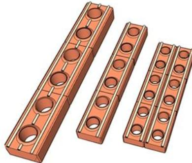
La colle doit être apposée dans le sens de la longueur des briques soit avec des cordons continus à l'aide d'une jointoyeuse, soit avec un peigne ou un rouleau (Il est donc préférable de poser les briques avec les chapeaux en dessous). Mettre de la colle dans le sens perpendiculaire crée des points d'appuis favorisant l'apparition possible de fissures ; La brique est très résistante en compression mais sensiblement moins solide en flexion.
